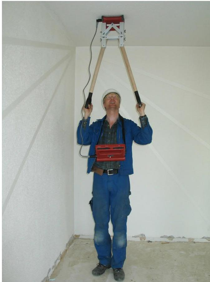
Stahlordnung mit einem „Scanner“.
